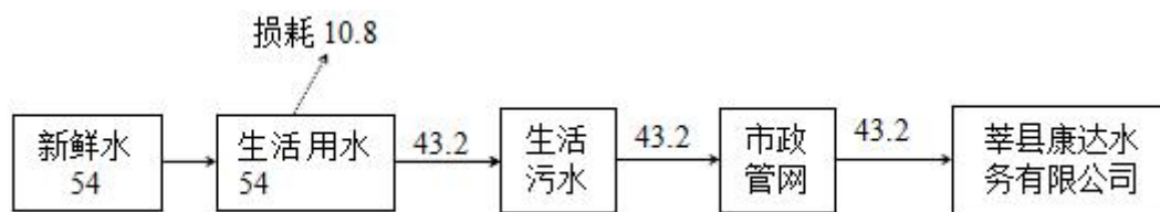
图 2-3 项目水平衡图 (m 3 /a)
