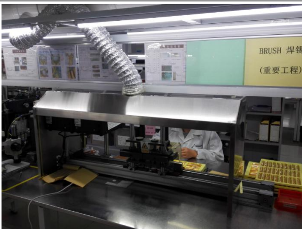
焊接工段集气罩
